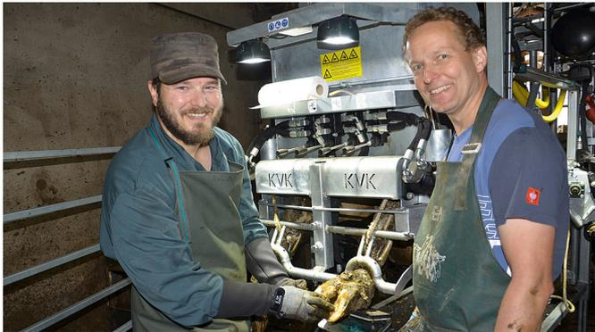
Der hydraulische Klauenpflegestand kann von einer Person in 5 - 10 Minuten aufgebaut werden. Klauenbehandlungen können sicher für Mensch und Tier durchgeführt werden.
